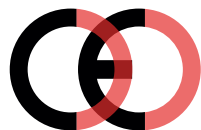
Marcatura CE contraffatta (troppo vicino)
